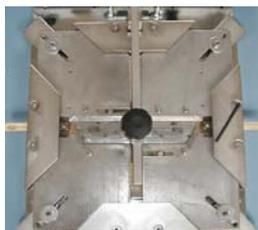
Macchina piegatrice per la conformatura delle tasche e delle pattine in genere. Corredata di ganasce universali per lo stiro delle tasche e di sistema vaporizzante incorporato per la produzione del vapore necessario allo stiro. Facile da regolare, le funzioni sono controllate dal Plc ed è adatta a qualsiasi tipo di tessuto. Disponibile anche solo per fessino manica (UNIVAPOR/F)
